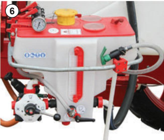
**6. Премиксерът** с работен обем 35 л може да се използва за приготвяне на работен разтвор или изливане на концентрат в основния резервоар. Дюзата за промиване на резервоарите изключва контакт с опасните вещества по време на работа, както и позволява да се използва тяхното съдържание без отпадъци.
