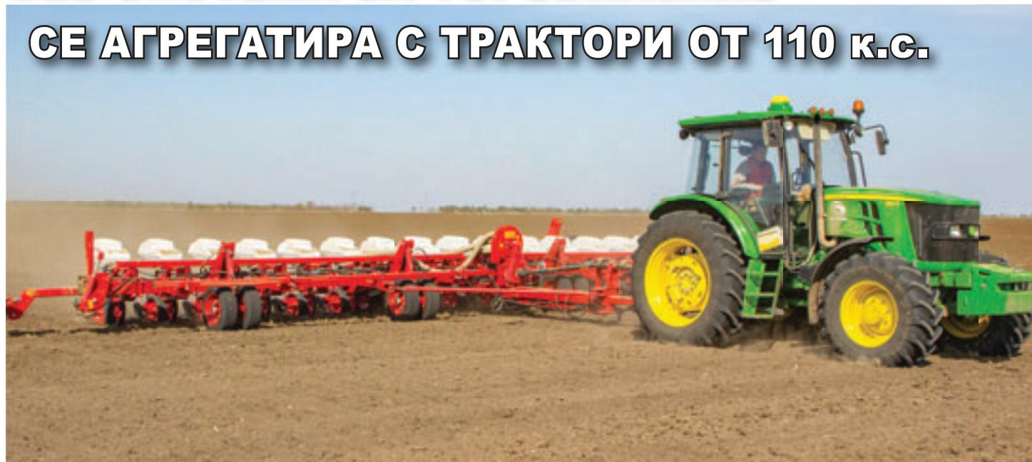
Голямата широчина на захват на сеялката **VEGA 16 PROFI** позволява по време на работа да се копира отклонението на терена във височина до 12%, спрямо вертикалната плоскост.
