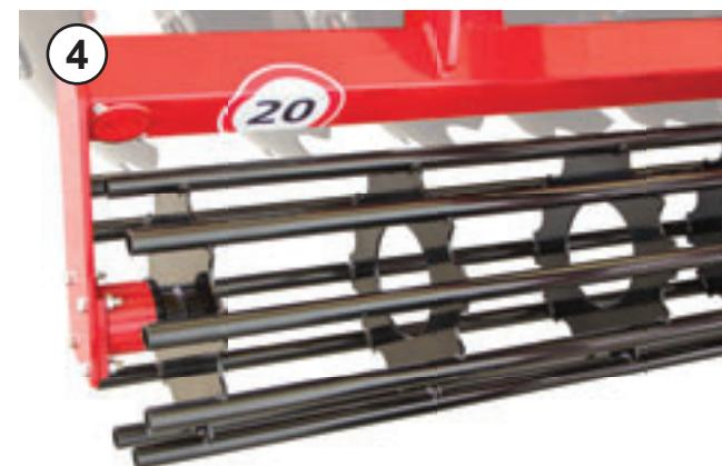
В базовата комплектация на модела **PALLADA** са предвидени валяци от тръбен тип. Използват при условия на ниска влажност на почвата.
