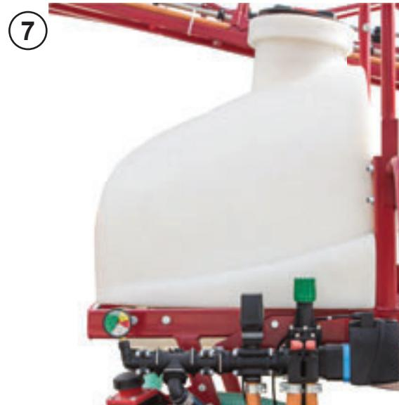
**7. Резервоарът за промиване** на системата с вместимост 200 литра осигурява максимално почистване на системата, на пръскачката от работната течност.
