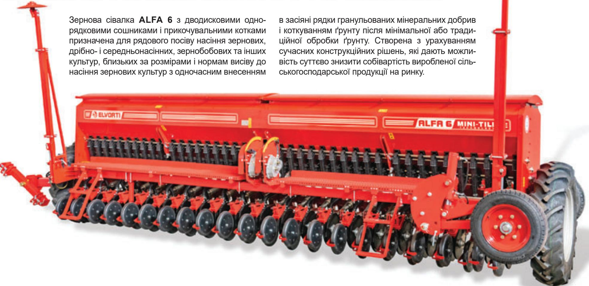
Зернова сівалка **ALFA 6** з дводисковими однорядковими сошниками і прикочувальними котками призначена для рядового посіву насіння зернових, дрібно- і середньонасінних, зернобобових та інших культур, близьких за розмірами і нормам висіву до насіння зернових культур з одночасним внесенням
